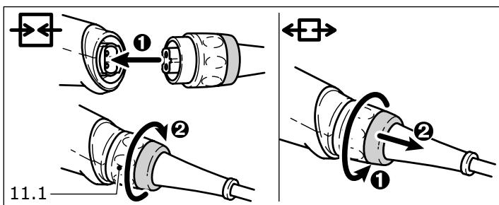
Pour installer le cordon d'alimentation, raccordez-le à l'orifice prévu à cet effet sur l'outil en veillant à ce que la clavette et la rainure de
