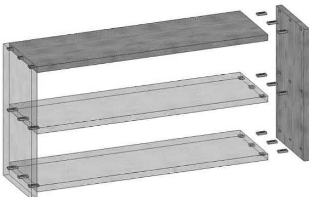
La utilización de ensambles a media madera con espigas es un método muy práctico para fabricar armazones de armario. Las espigas constituyen un apoyo resistente para cada una de las particiones horizontales de un armario.
