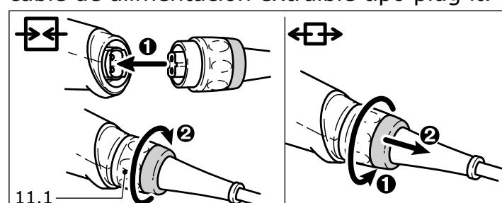
Para colocar el cable de alimentación, introdúzcalo en el orificio de entrada de la
