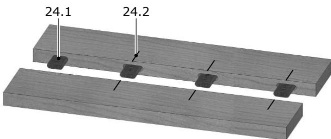
Pour l'assemblage bord à bord, une série de tenons est placée le long de l'assemblage. Le premier tenon [24.1] permet de disposer les deux planches horizontalement, l'alésage est fraisé à une largeur standard. Les autres tenons permettent d'aligner les planches à un même niveau et les alésages peuvent être fraisés à une largeur supérieure.
