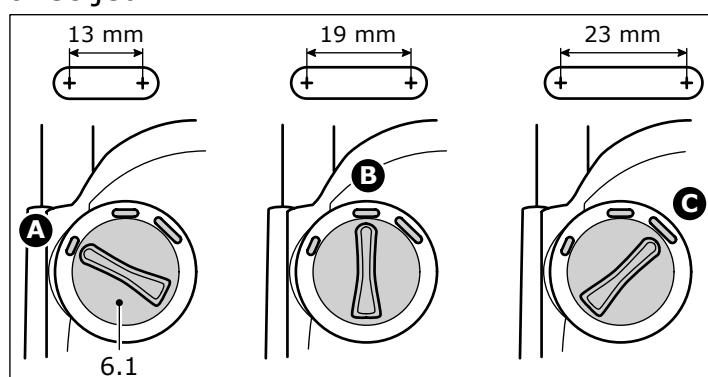
En position standard (trait court) [A], la largeur de la mortaise correspond exactement à celle du tenon Domino. La largeur de la mortaise mesure alors 13 mm + le diamètre de la fraise. En position "trait moyen" [B], la largeur de la mortaise est plus grande de 6 mm par rapport à celle du tenon Domino. En position "trait long" [C], la largeur de la mortaise est plus grande de 10 mm par rapport à celle du tenon Domino.
