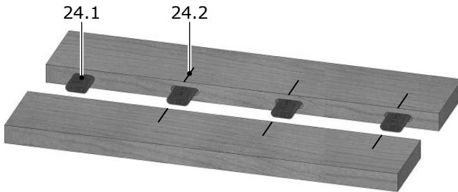
El ensamblaje de bordes de tablas es un método habitual para obtener tablas de grandes dimensiones a partir de un conjunto de tablas de menor tamaño. Las espigas Domino aumentan la resistencia del ensamblaje y también contribuyen a alinear adecuadamente las tablas.
